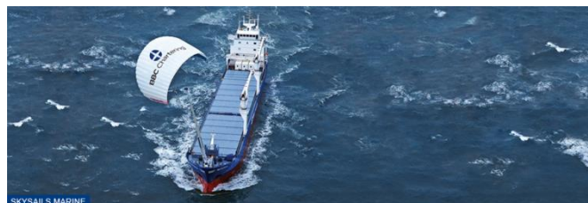
Rys.2. Wspomaganie napędu statku żaglami w postaci latawców [źródło: http://www.skysails.info/english/skysails-marine/skysails-propulsion-for-cargo-ships/ ]
