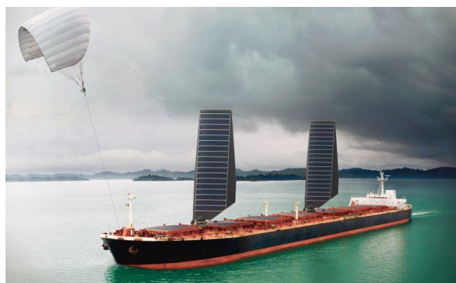
Rys.3. Wykorzystanie paneli słonecznych i żagla do zmniejszenia zapotrzebowania na energię przez statek [źródło: https://forums.sufficientvelocity.com/threads/sailing-ships-for-the-information-age-environmentally-friendly-transport-methods.22161/ ]
