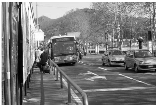
Fot. 3. Przykład krótkiego odcinka, na którym pojazdy skręcające w prawo mogą korzystać z pasa autobusowego – Genua (fotografia własna)
