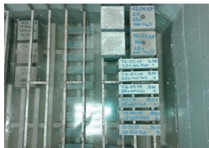
Rys. 4. Dojrzewanie próbek nad i pod wodą
