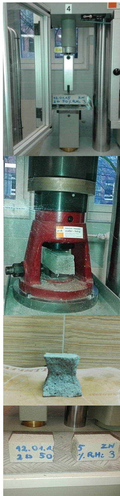
Rys. 5. Badanie wytrzymałości na ściskanie i zginanie
