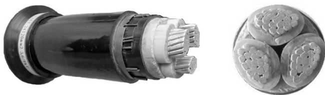
Rys. 2. Kabel elektroenergetyczny YAKY z żyłami aluminiowymi, o izolacji polwinitowej, z żyłą powrotną miedzianą nałożoną na powłokę, o powłoce polwinitowej ( U_n = 3,6/6 kV)
