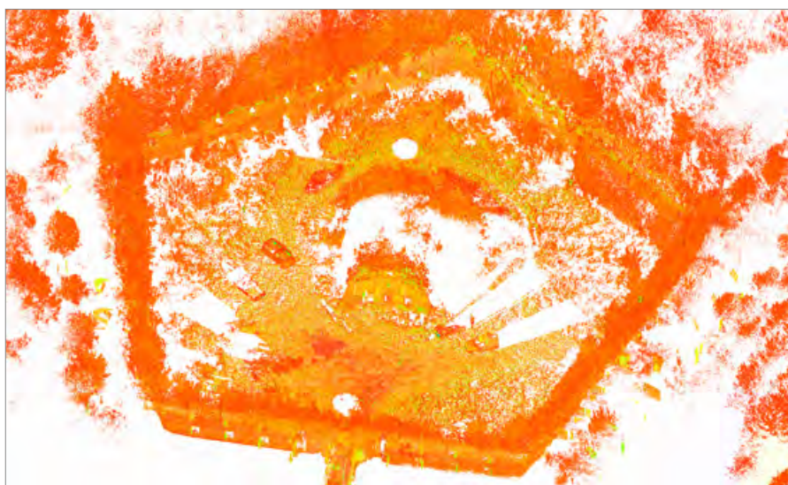
Ryc. 2. Chmura punktów TSL pokolorowana intensywnością odbicia promienia laserowego
