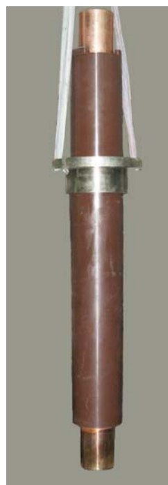
Rys. 8. Izolator po wyjęciu z formy
