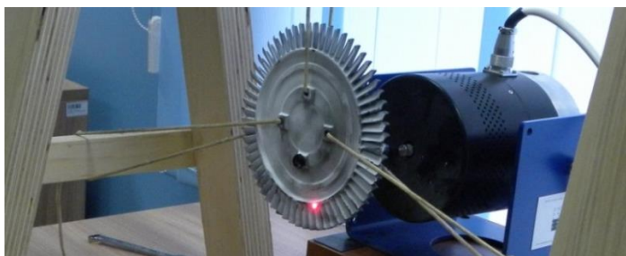
Rys. 4. Sposób zamocowania tarczy na stanowisku pomiarowym
