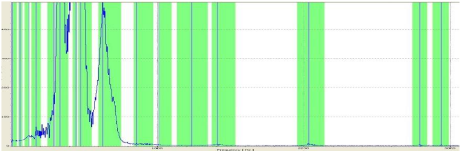
Rys. 10. Widmo częstotliwościowe z zaznaczonymi pikami rezonansowymi dla łopatki
