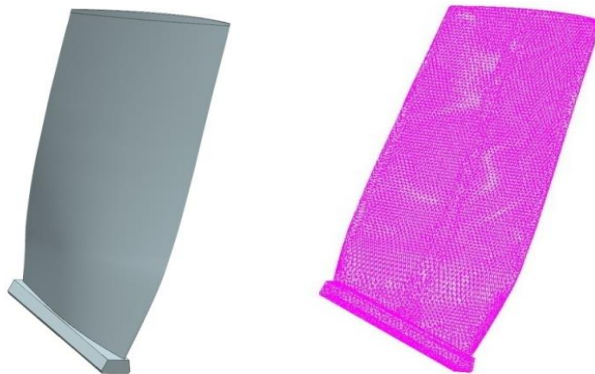
Rys. 12. a) model geometryczny łopatki w środowisku NX, b) model dyskretny łopatki
