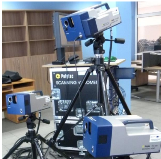
Rys. 1. Skanujący wibrometr laserowy PSV-400-3D z trzema głowicami pomiarowymi. Na górnej głowicy zainstalowana jednostka skanowania geometrii
