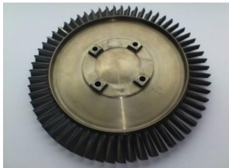
Rys. 3. Zintegrowana tarcza turbiny silnika rozruchowego AI-9
