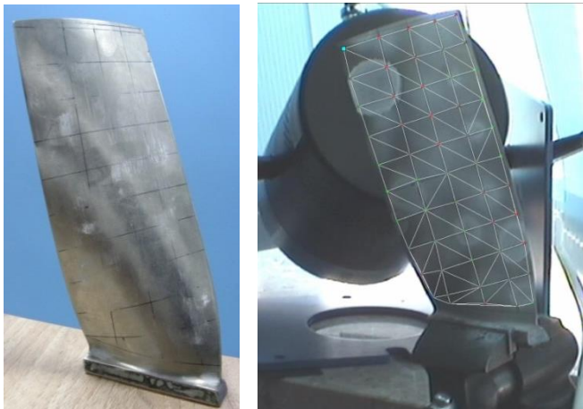
Rys. 9. a) badana łopátka, b) sposób mocowania oraz siatka pomiarowa
