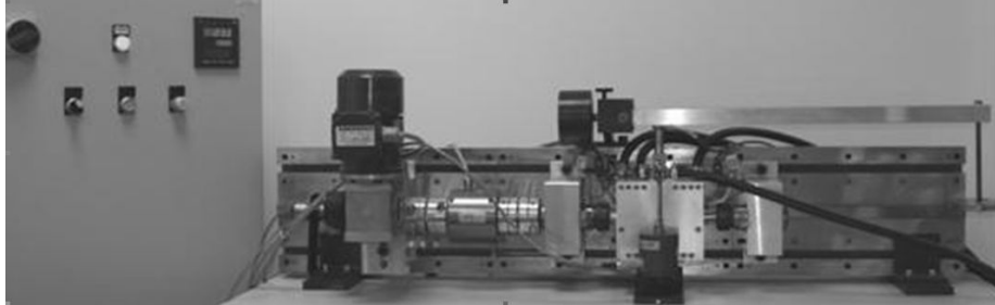
Rys. 9. Tester TWT-500N do badań układu wałek-panewka Fig. 9. TWT-500N tester for testing of a shaft-cup system
