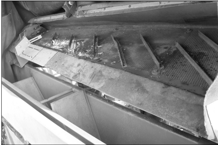
Rys. 2. Płyta robocza powietrznego stołu koncentracyjnego typu FGX-1; fot. W. Sobko Fig. 2. Separating deck of the FGX-1 air concentrating table; photo by W. Sobko
