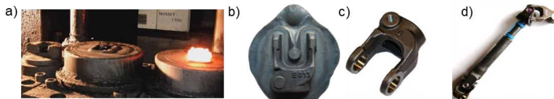
Rys. 1. Widok: a) dolnych wkładek matrycowych wraz z przedkawką umieszczoną przed kuciem wykańczających w wykroju wkładki, b) przykładowa odkuwka typu rozwidłonego z wyływką, c) gotowy detal - po obróbce mechanicznej, d) fragment kolumny kierowniczej z widłakami
