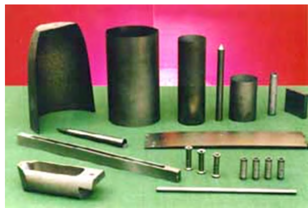
Rys. 7. Wyroby z pirografitu i kształtki grafitowe pokryte pirografitem, wykonane w IBJ/ICH TJ
