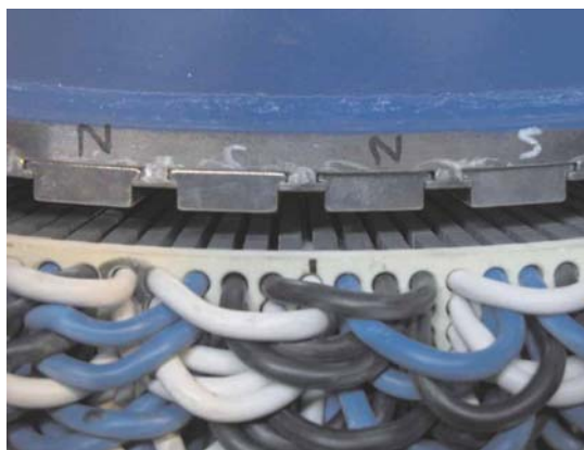
Rys. 11. Uzwojenie twornika eksperymentalnej prądnicy wykonanej na Uniwersytecie w Uppsali
