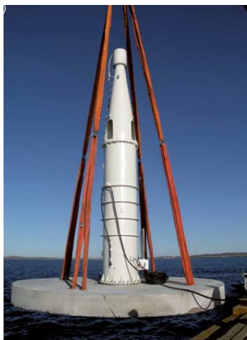
Rys. 10. Elektrownia pływakowa wykonana na Uniwersytecie w Uppsali
