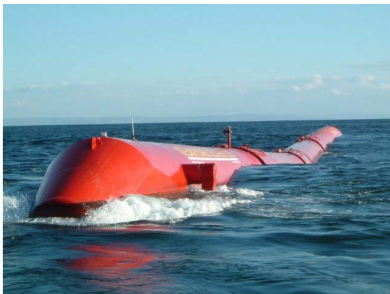
Rys. 4. Fotografia wykonanego urządzenia Pelamis zwanego „wężem morskim”
