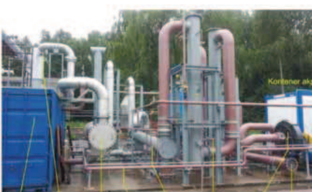
Kontener maszyn robo- Wylot gazu PZW z wymiennik gaz / Woda chłodząca Główny Chłodnice Wyprowadzenie do instalacji czy: cyklonu powietrze z jonitów do chłodnicy wentylatoro- snoj pionowe Węntylator dopalacza (przed montażem) Wydmuch powietrza regeneracji złoża Adsorbenty rewersyjne Zbiornik separujący skrubera (odkraplacz) Skruber Venturi Separator i zbiornik cząstki stałych
