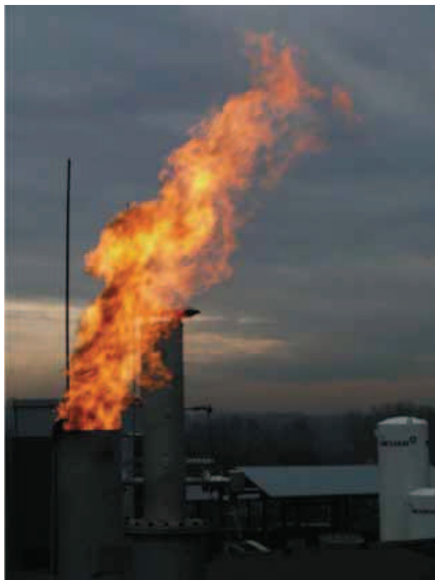
Rys. 4. Spalanie gazu procesowego ze zgazowania węgla przy wykorzystaniu CO 2 (widok pochodni).
