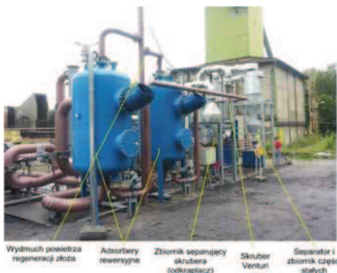
Rys. 1. Infrastruktura powierzchniowa pilotowej instalacji podziemnego zgazowania węgla w KWK „Wieczorek”
