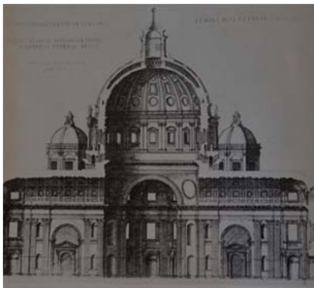
Rys. 4. Bazylika św. Piotra – przekrój przez budynek i widok kopuły wg projektu Michała Anioła [8].
