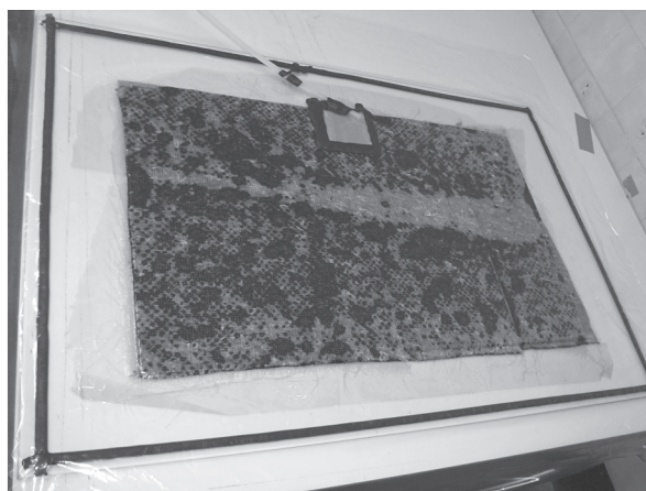
Rys. 1. Wytwarzanie biokompozytu metodą worka próżniowego
