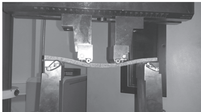
Rys. 4. Statyczne zginanie czteropunktowe próbki biokompozytu z materiałem rdzeniowym Corecork NL20 o grubości 6 mm Fig. 4. Static four-point flexural test of biocomposite sample with Corecork NL20 in 6 mm thickness as a core
