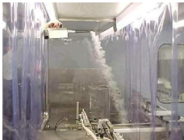
Rys. 2 badanie obiegu powietrza wewnątrz laboratorium [11]
