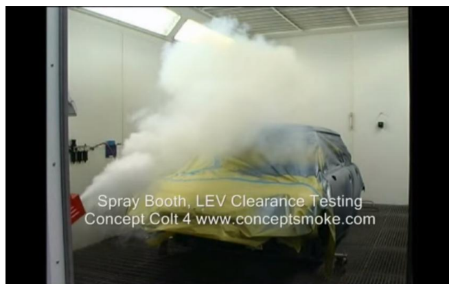
Rys. 1 badanie opływu powietrza wokół pojazdu umieszczonego w kabine lakierniczej[10]
