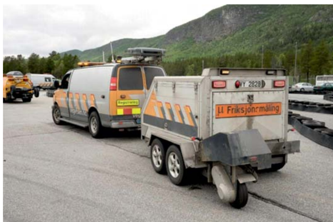
Fot. 4. Rutynowe pomiary porównawcze na terenie testowym z udziałem urządzenia OSCAR oraz 5 zestawów regionalnych ROAR
