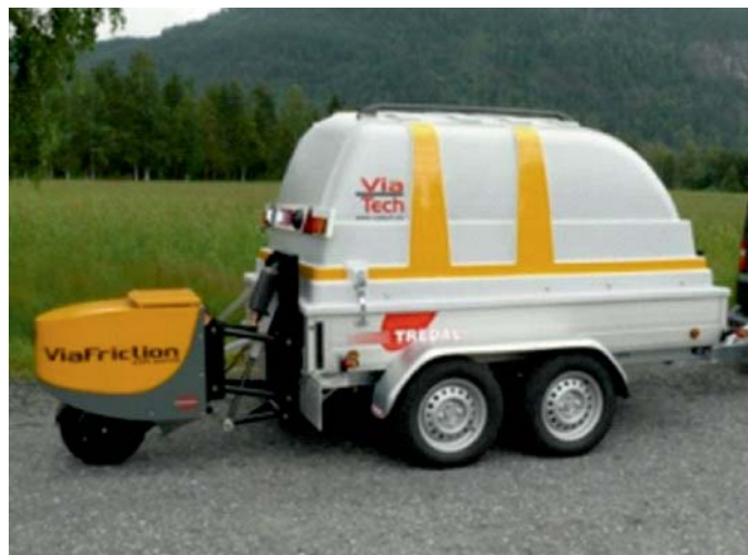
Fot. 2. Urządzenie ViaFriction stosowane przez NPRA do pomiarów współczynnika tarcia na sieci drogowej
