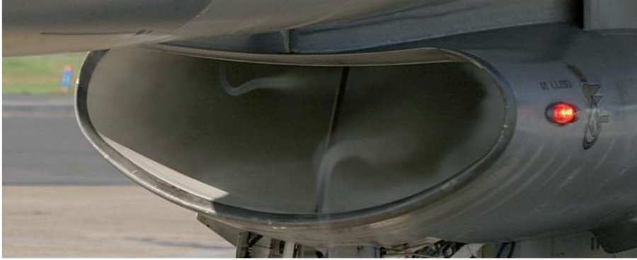
Rys. 1. Przykładowe nierównomierność strumienia (wirów wlotowe i oderwania) we wlocie samolotu F-16 [12].
