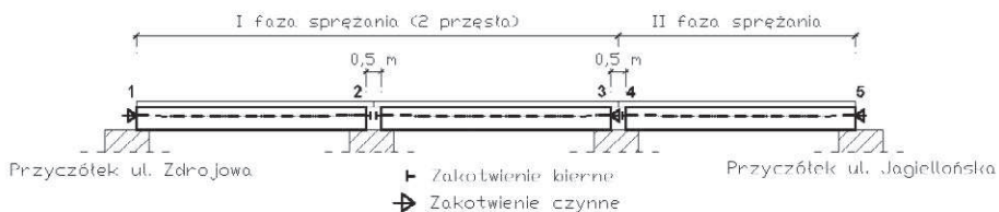
Rys. 11. Schemat sprężania mostu
