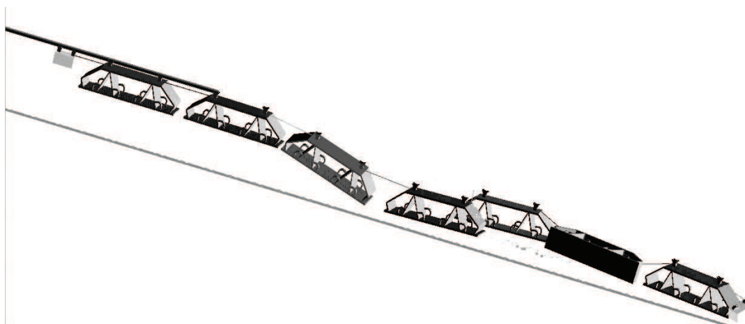
Rys. 10. Symulacja zerwania trasy kolejki podwieszanej [Źródło: opracowanie własne]
