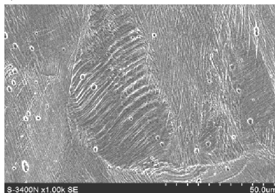
Rys. 3. Wybrane przykłady struktury stali G18H18 (ASTM A289 - class C). Struktura wejściowa (a) i po wpływie obciążenia zmęczeniowego (b)
