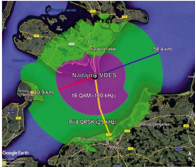
Rys. 4. Teoretyczne zasięgi użyteczne systemu VDES (MCS-1 i MCS-5) dla wysokości zawieszenia anteny 18 m
