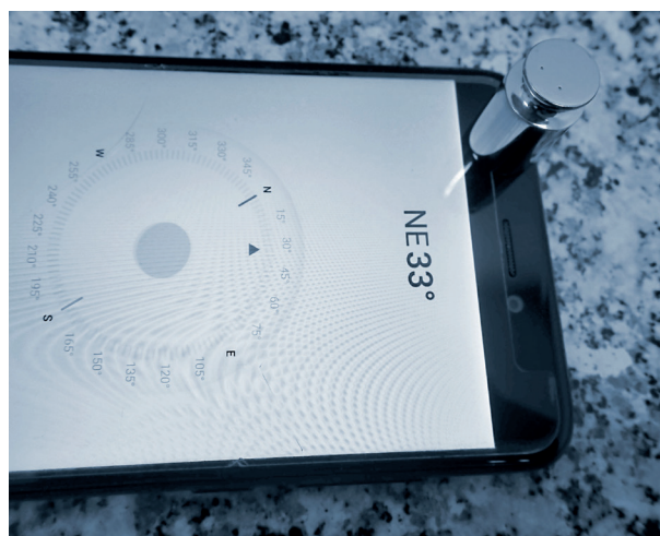
Rys. 7. Wzorzec masy 10 g, klasy dokładności E 2 . Polaryzacja zmierzona za pomocą susceptometru wynosi 25 μT
