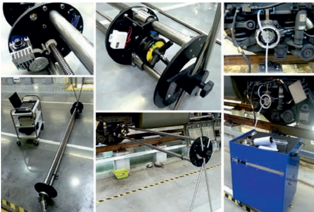
Rys. 9. Widok aparatury badawczej wraz z widokiem montażu urządzenia do dopływu oleju [10]
