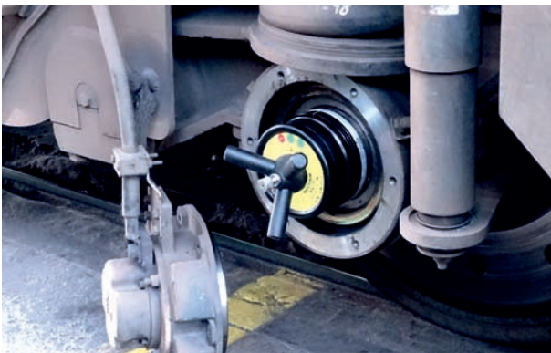
Rys. 4. Widok defektoskopu w położeniu roboczym [9] Fig. 4. View of the defectoscope in the working position [9]
