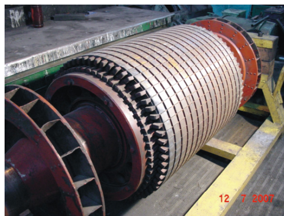
Rys. 5. Zmodernizowany wirnik silnika 2000/500 kW stan po odbyciu 70.000 rozruchów
