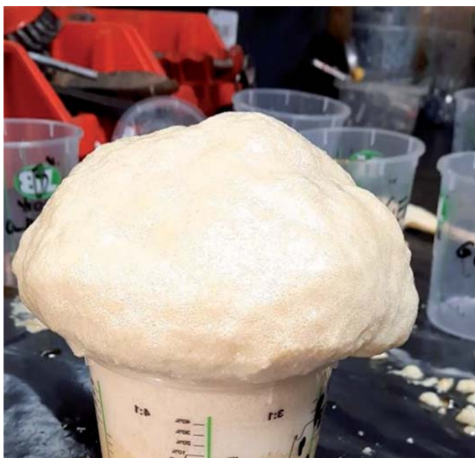
Fot. 6. Próbką materiału Geofiller 2K – po zmieszaniu komponentu A i B
