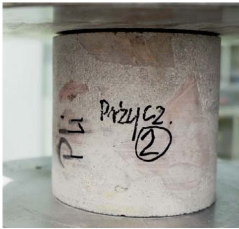
Fot. 3. Próbkę walcową między płytami maszyny wytrzymałościowej
