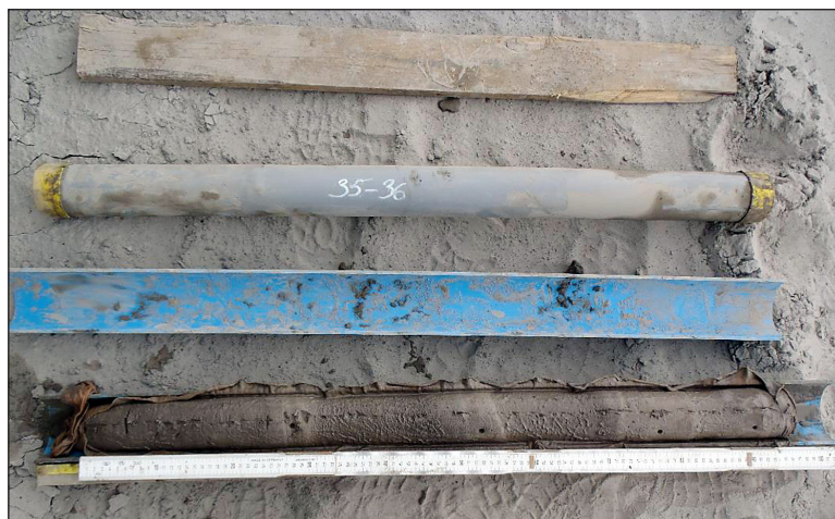
Rys. 3. Rdzeń osadów pobrany próbnikiem MOSTAP
