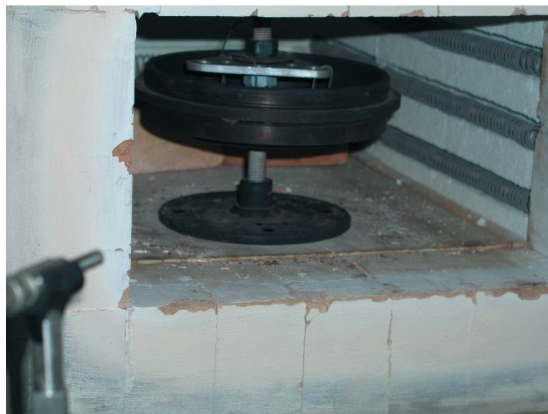
Rys. 3. Stanowisko badawcze do wyznaczenia częstotliwości drgań własnych bębna hamulcowego – bęben umieszczony w piecu grzewczym
