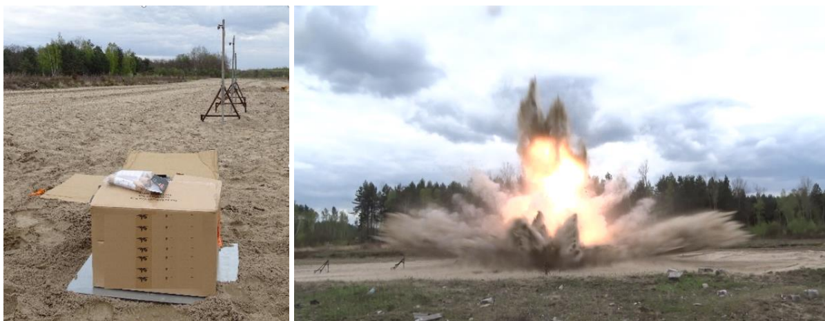
Fot. 12. Stanowisko badawcze do testu 6 i efekt wybuchu masowego
