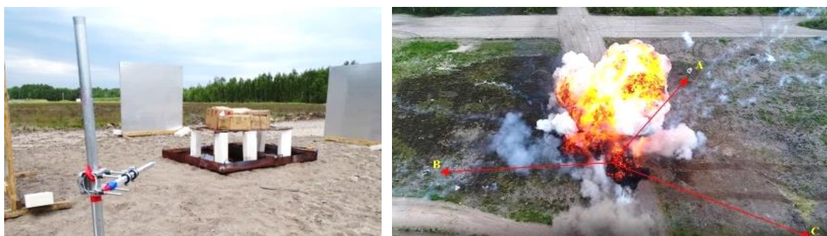
Fot. 14. Stanowisko badawcze do testu 6(c) i efekt wybuchu masowego zarejestrowany kamerą umieszczoną na dronie Photo 14. Testing set-up for test 6(c) and effect of mass explosion recorded by a drone camera
