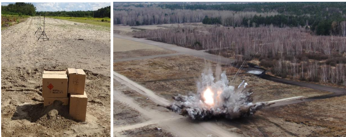
Fot. 13. Stanowisko badawcze do testu 6(b) i efekt wybuchu masowego Photo 13. Testing set-up for test 6(b) and the effect of mass explosion
