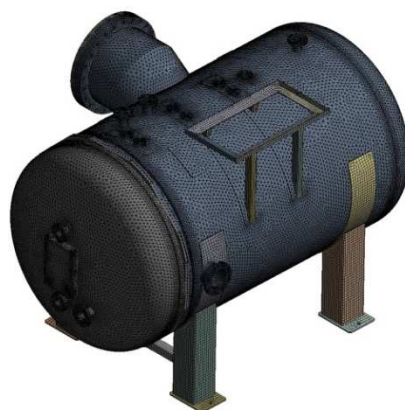
Rys. 3. Model dyskretny zbiornika ciśnieniowego Fig. 3. Discrete model of the pressure vessel
