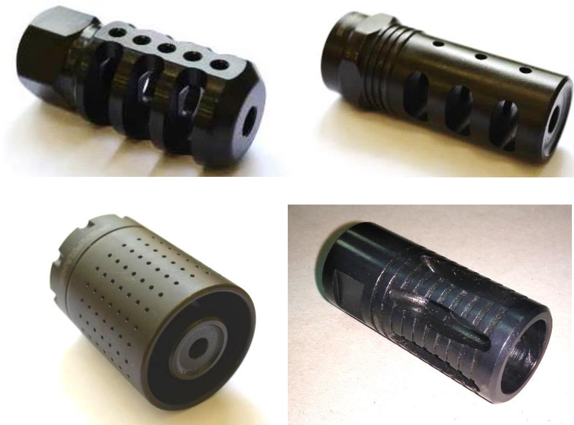
Fot. 3. Urządzenia wylotowe badane na karabinku wyborowym; góra, od lewej: Accu-Tac TANK II (UW1), Ferfrans MBM (UW2); dół, od lewej: Ferfrans MBM+CRD (UW3), FB "Łuczniczka" - Radom (UW4)
