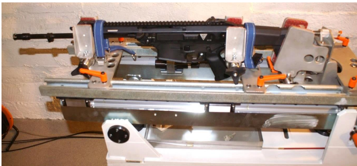
Fot. 5. Karabinek zamontowany na stanowisku badawczym Photo 5. The rifle assembled on the testing stand
