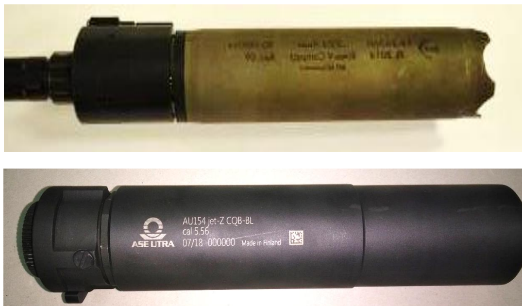
Fot. 4. Tlumiki dźwięku badane na karabinku wyborowym, od góry: B&T Rotex-V Compact (TD1), ASE UTRA jet-Z CQB-BL (TD2)
