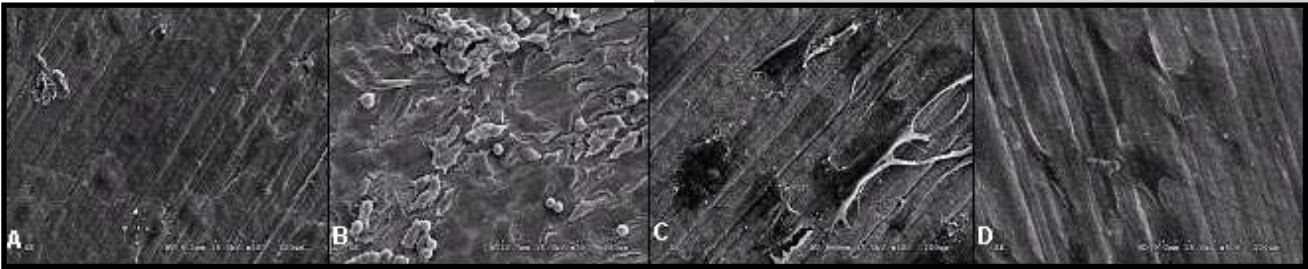
RYS.1. Rozmieszczenie i morfologia osteoblastów linii Saos-2 (A, B) i fibroblastów (C, D) na warstwach typu TiN+Ti 2 N+αTi(N) po (A, C) i przed (B, D) litografią.
