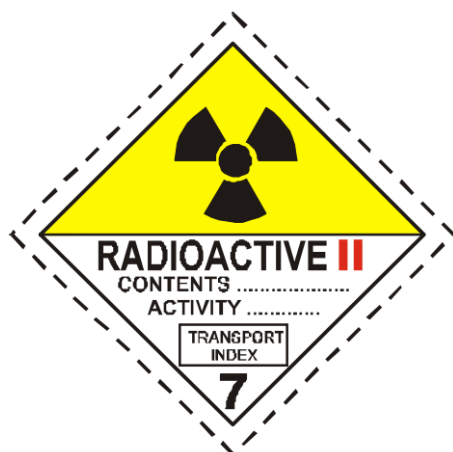
Rys. 2. Nalepka nr 7 B, Kategoria II – Żółta informująca o zagrożeniu klasy 7 – Materiały promieniotwórcze
