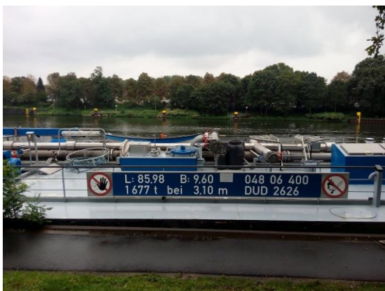
Rys. 3. Przewóz oleju napędowego (UN 1202) zbiornikowcem – przewóz śródlądowy, zgodnie z przepisami Umowy ADN.
