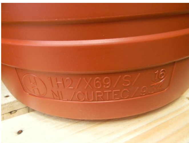
Rys. 1. Przykład certyfikowanego opakowania do przewozu towarów niebezpiecznych – bęben z tworzywa sztucznego z wiekiem zdejmowalnym (1H2)
