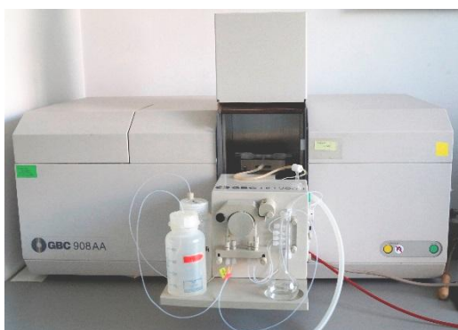
Rys. 3. Spektrometr absorpcji atomowej GBC 908 AA z generatorem wodorków HG3000 (technika 1).
