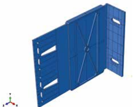
Rys. 4. Geometria numeryczna badanej konsoli pasywnej modelu M1; źródło: autor
