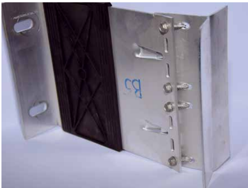
Rys. 19. Efekt wyciągnięcia wkrętów uzyskany w badaniach laboratoryjnych; źródło: autor
