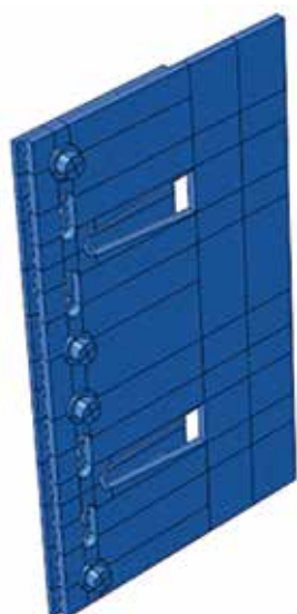
Rys. 5. Geometria numeryczna badanej konsoli pasywnej modelu M2; źródło: autor
