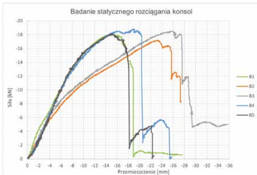
Rys. 17. Zestawienie wyników nośności konsoli poddanych statycznemu rozciąganiu; źródło: autor
