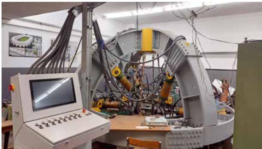
Rys. 2. Przestrzenna maszyna wytrzymałościowa; źródło: autor
