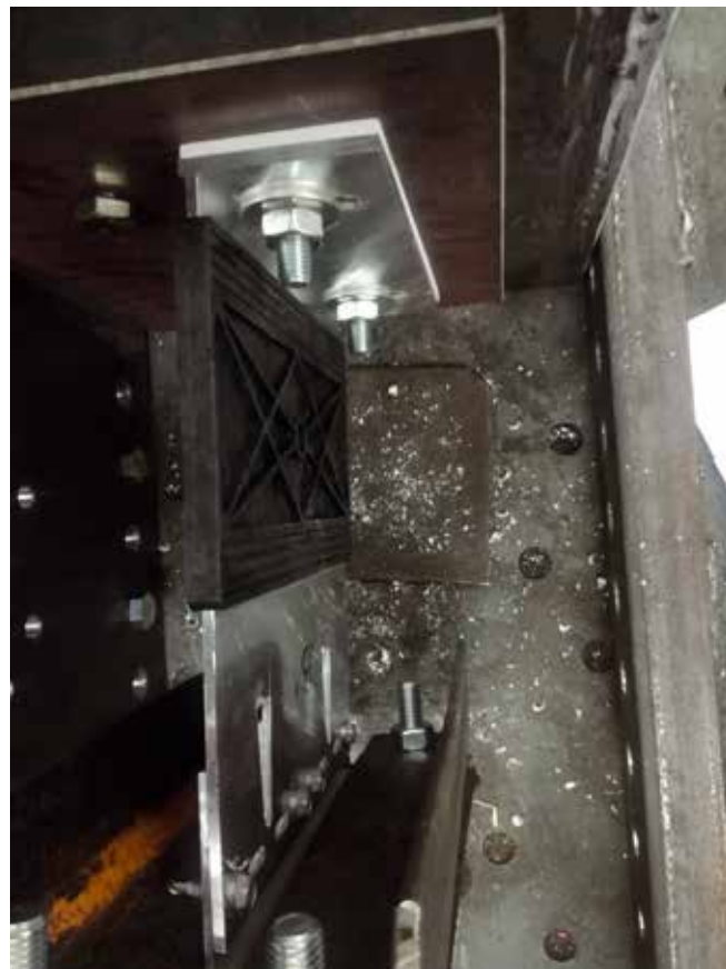
Rys. 16. Odsztącenia uzyskane w ramach badań laboratoryjnych dla zakotwienia skrajnie do wewnątrz; źródło: autor
