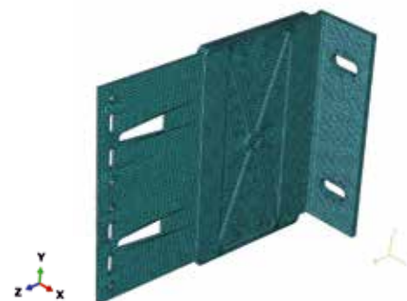
Rys. 6. Siatka MES modelu M1; źródło: autor
