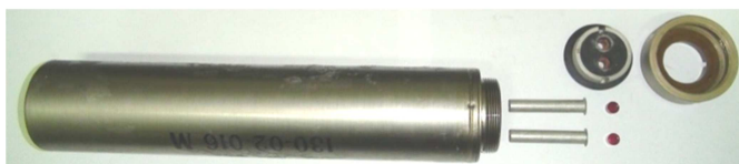
Fot. 5. Układ pobudzający do torpedy SET przygotowany do kompletacji
