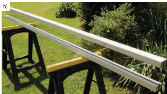
Rys. 5. b) Widok belki zespolonej drewniano-szklanej bezpośrednio po wytworzeniu w warsztacie stolarskim
