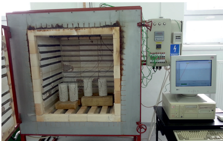
Ryc. 3. Próbkę z betonu porowatego umieszczone w piecu PK1100/1 Fig. 3. Specimens of porous concrete placed in PK1100/1 furnace
