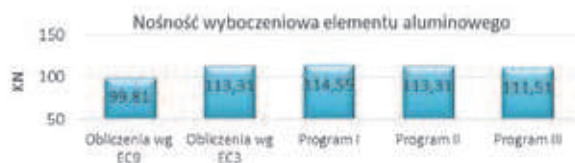
Rys. 2. Nośność na wyboczenie elementu aluminiowego
