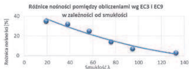
Rys. 3. Różnice w nośności na wyboczenie kształtownika aluminiowego
