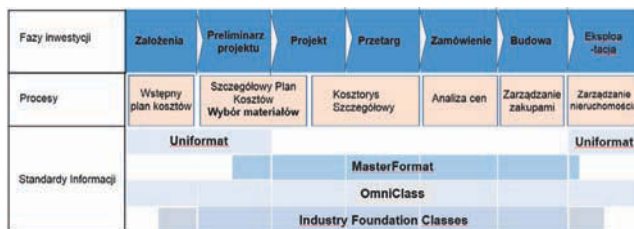
Rys. 1. Systemy klasyfikacji w analizach kosztowych w cyklu życia przedsięwzięcia budowlanego. Źródło: opracowanie własne
