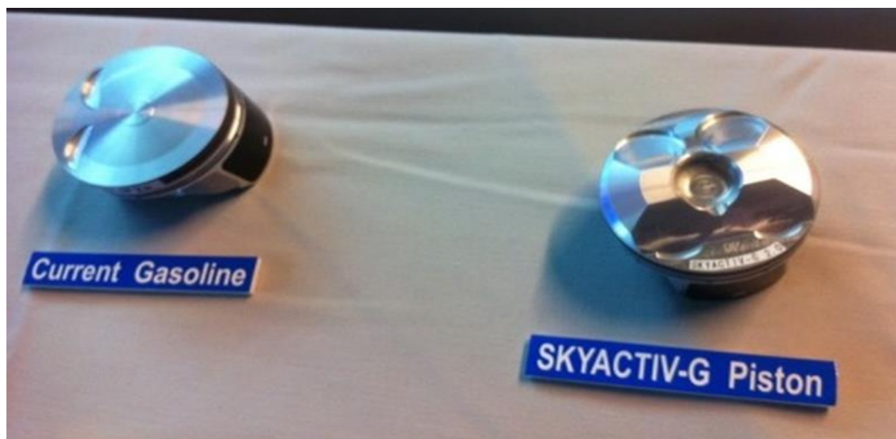
Rys. 4. Porównanie konwencjonalnego tłoka silnika o ZI z tłokiem silnika o wysokim stopniu sprężania [8].
