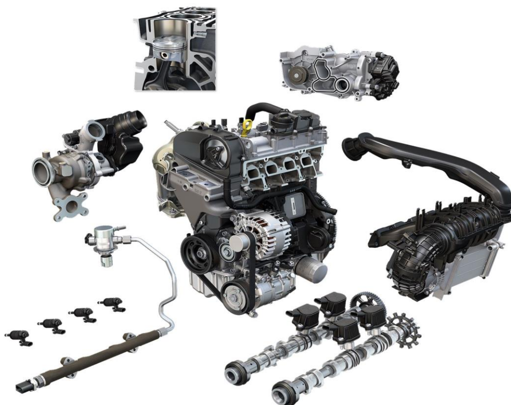
Rys. 6. Nowoczesny silnik grupy VAG 1.5 TSi wtkorzystujący rozwiązania downsizingowe oraz rightsizingowe [8].
