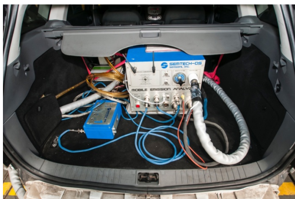
Rys. 5. Badany pojazd z zamontowaną aparaturą badawczą Semtech DS.
