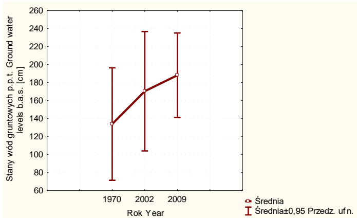
Rys. 8. Zmienność stanów wód gruntowych
