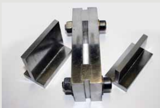
Rys. 3. Forma stalowa do prasowania próbek badawczych w formie beleczek.
