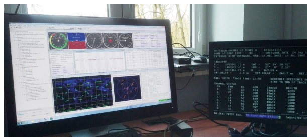
Rys. 4. Analiza scenariuszy obejmujących najbliższy GPS rollover, z wykorzystaniem symulatora sygnałów GNSS
