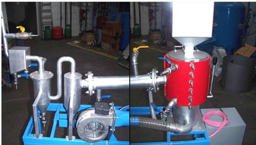
Rys. 2. Zdjęcie instalacji do zgazowania
