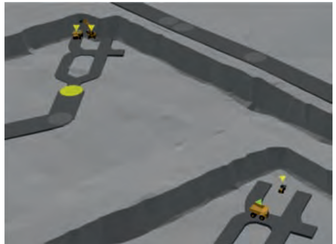
Rys. 2. Model frontów wydobywczych z punktami załadunku w programie HaulSim
