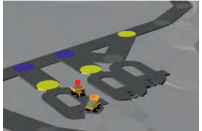
Rys. 8. Miejsca wyładunku symbolizujące leje zasypowe w łamiarni Fig. 8. Unloading points symbolizing hoppers in the crushing plant
