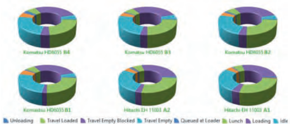
Rys. 18. Wygenerowane w raporcie symulacyjnym poglądowe wykresy czasów trwania stanów pracy wozidel Fig. 18. Demonstrative graphs of haul trucks stages of work duration generated in the simulation report
