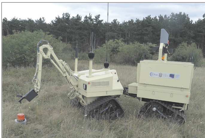
Rys. 1. Bezzałogowa platforma lądowa z urządzeniem do kontroli łączności przeciwnika
