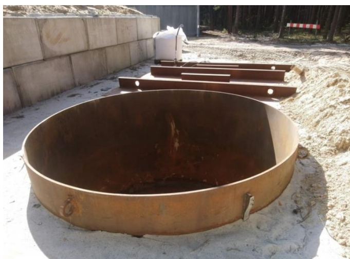
Rys. 2. Stalowa beczka zaprojektowana w celu przeprowadzania badań fragmentacji pocisków
